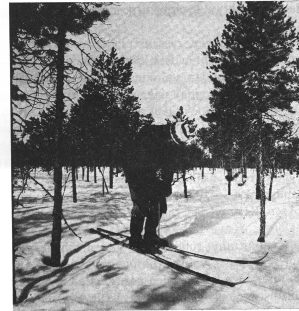
Kuva 15. Pintaturpeen routakerroksen läpäisevyyttä mitattiin lumen päältä kartiopenetrometrillä. Kuva on otettu ojittamattomalta puustoiselta rämekeosalalta.
