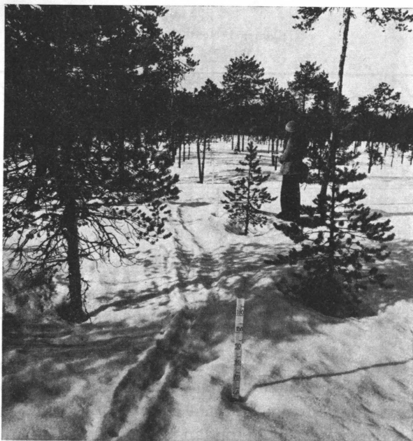
Kuva 11. Lumen syvyys mitattiin kiinteillä lumisauvoilla, jotka oli asennettu kahteen linjaan ja joita oli 26 kpl kullakin koealalla.
