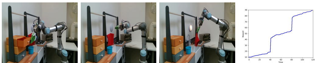
(d) close the drawer then open the light then open the oven door
