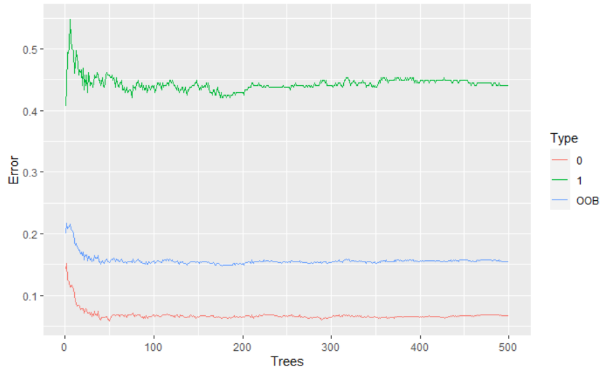
Figure 2: Comportamiento del modelo con respecto a cada clase de predicción. Observe como los árboles se empiezan a estabilizar a partir del valor 16 aproximadamente, para el tipo 1 (Clase 1) y OOB , mientras que para el tipo 0 (Clase 0), se empieza a estabilizar en 200 aproximadamente. Esta inspección visual permite establecer el valor de los árboles en 500.
