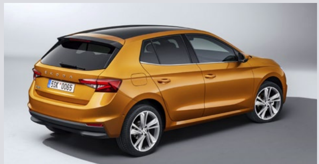
Zum ausgezeichneten c_w -Wert von 0,28 trägt unter anderem der Heckspoiler mit seitlichen Finnen bei
