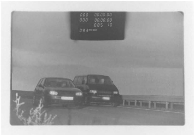
**Abbildung 4 – Verkehr auf mehreren Fahrstreifen, Überholverkehr, gültiger Messwert**
