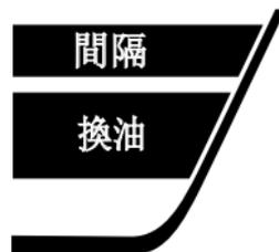
機油更換指示燈亮起，提醒您更換發動機機油。指示燈在最初的1000公里處亮起，此後預設間隔。預設間隔可在500公里至5000公里之間以500公里為步長進行調整。更換機油後，請關閉指示燈以重設指示燈。
