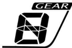
檔位指示器指示檔位。當變速器處於空檔時，該指示器顯示“N”。
