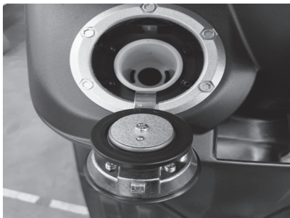
油箱蓋開啟狀態；加滿油之後將油箱蓋向加油口壓入即可恢復油箱蓋關閉狀態
